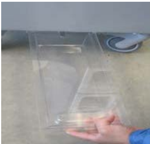
Figura 6: Instalação do Depósito de Drenagem
