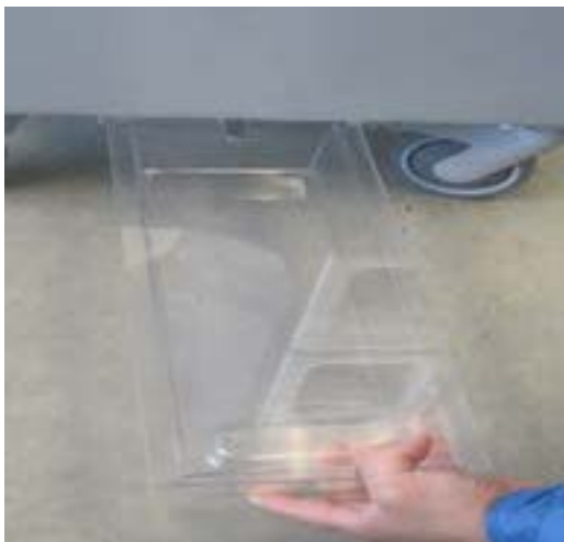
Rys. 6: Instalacja zbiornika ociekowego
