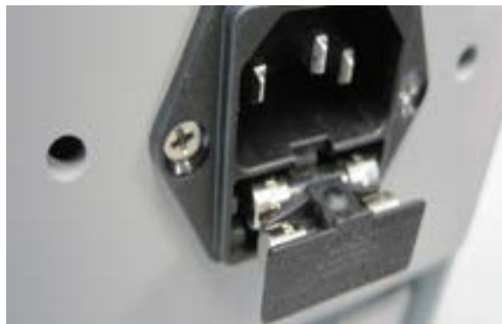
Rys. 9: Otwieranie szufladki na bezpieczniki
