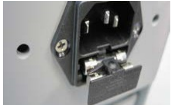
Figura 9: apertura de la caja de fusibles
