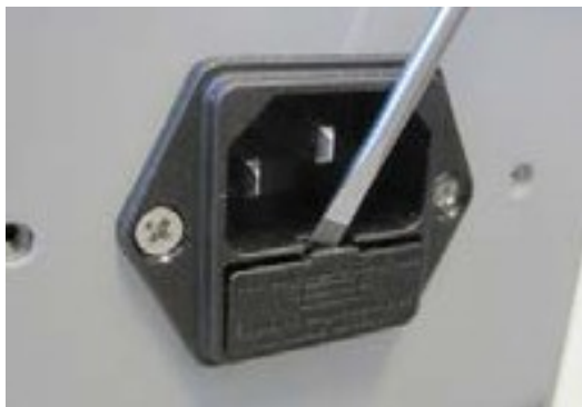
Rys. 8: Otwieranie szufladki na bezpieczniki
