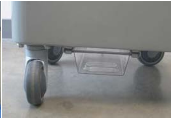
Afbeelding 7: Het geplaatste afvoerreservoir
