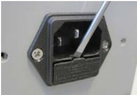
Figura 8: apertura de la caja de fusibles
