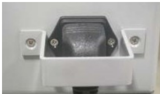
Figura 3: Instalação do Cabo de Alimentação
