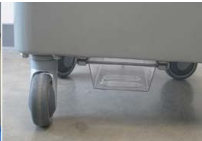
Obrázek 7: Zcela zasunutá vypouštěcí nádržka
