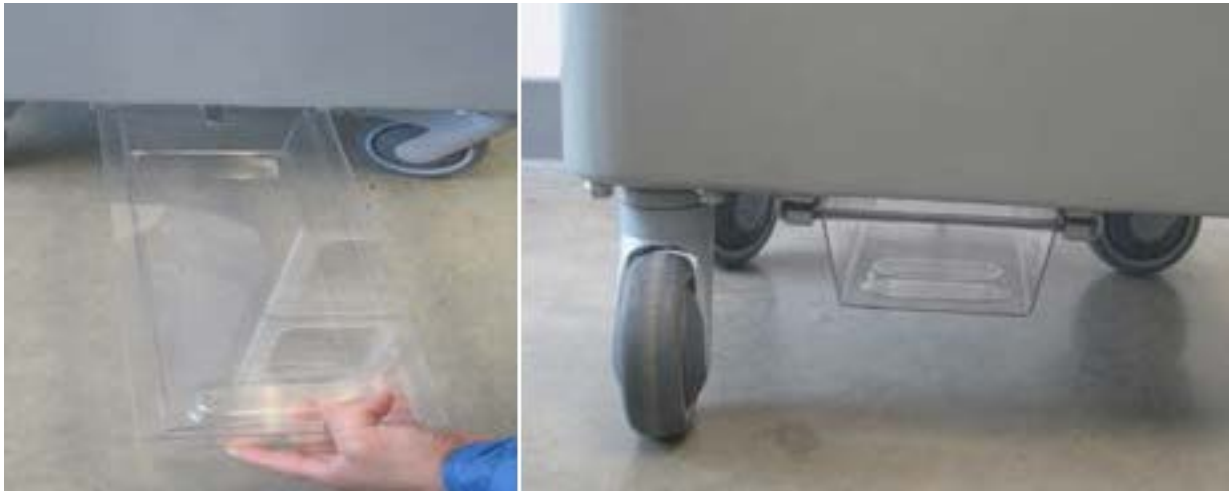
Figura 6: instalación del depósito de drenaje Figura 7: depósito de drenaje totalmente asentado
