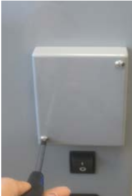
Figura 4: Rimozione del coperchio del controller
