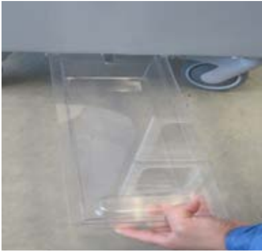
Figura 6: Installazione del serbatoio di scarico
