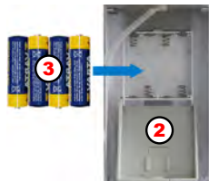
Abb. 8: Batterien einlegen (4 x AA Mignon LR6)
