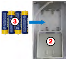
Abb. 3: Batterien einlegen (4 x AA Mignon LR6)
