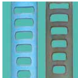
Abb. 3: Ausschnitt – Titanvalven: Linke Valve – fabrikneu. Rechte Valve – maschinell gereinigt.
