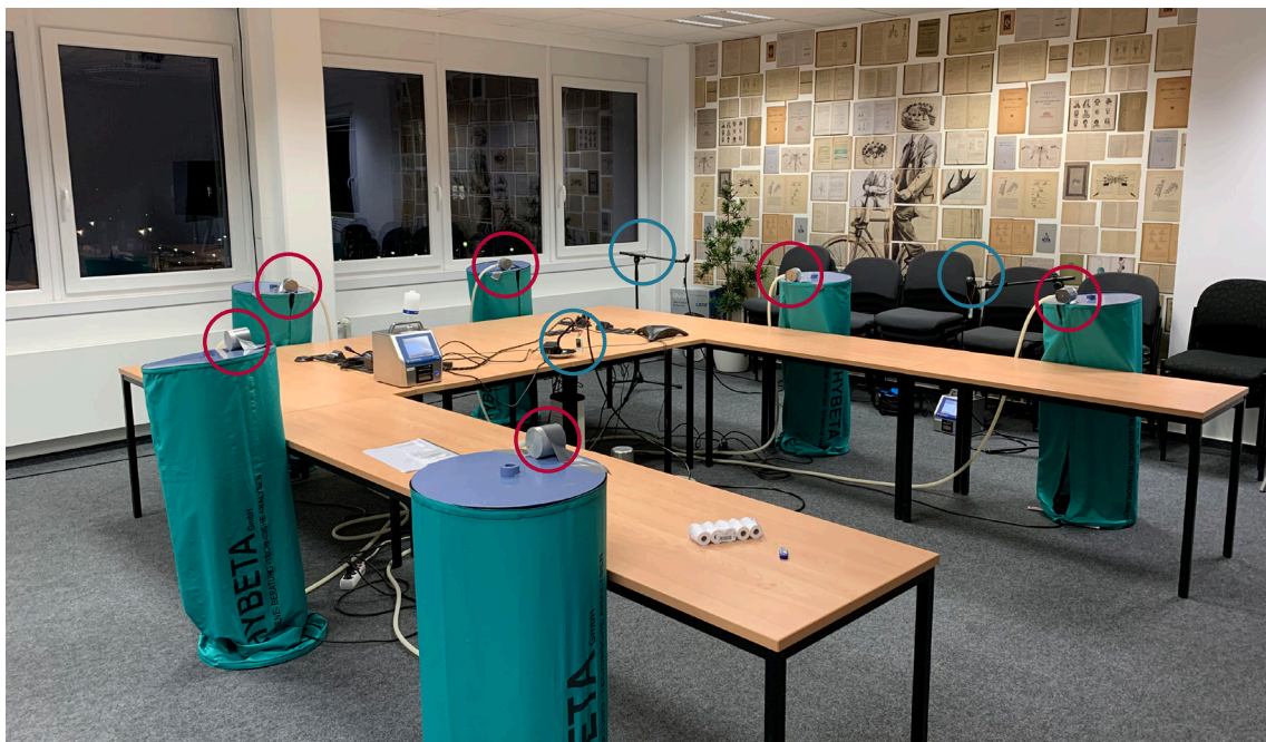
Abb. 1: Versuchsaufbau mit Dummies und Aerosolauflabepunkten und Messpunkten
