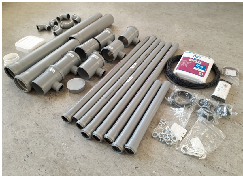
Abb. 1: Materialien für ein Entlüftungssystem für Besprechungsraum.
